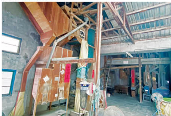
■ 玉生碾米工廠的木製碾米機 — 前為精米機、後為礱穀機
