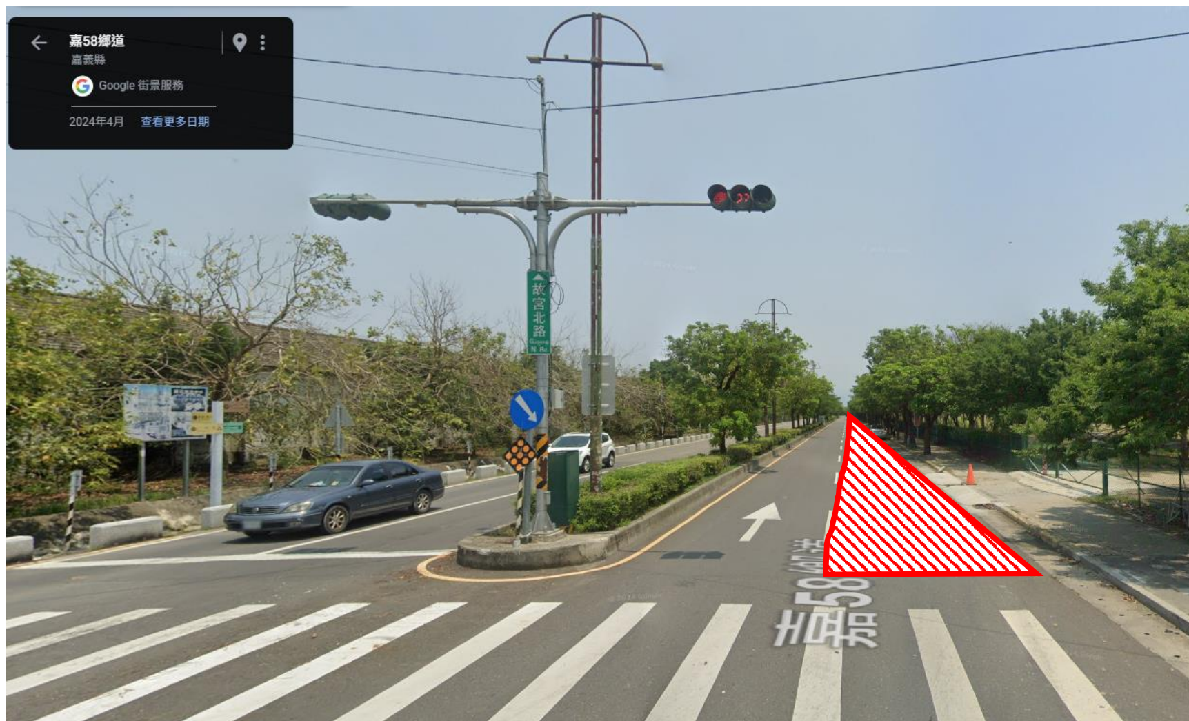
封閉東行方向最外側車道(內側車道開放汽、機車通行)
