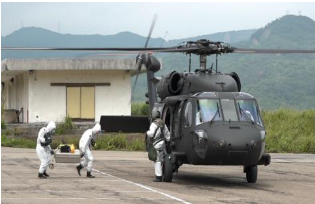
空域輻射偵測-偵檢器上機作業
